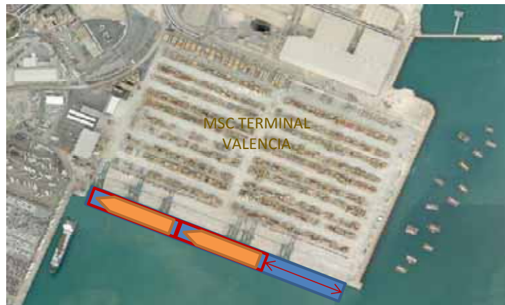
Figura 8. Muelle de MSCTV antes de su ampliación conceptualizado como una línea continua.
