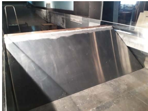
Figure 2. Photo de la digue avec pente lisse.
