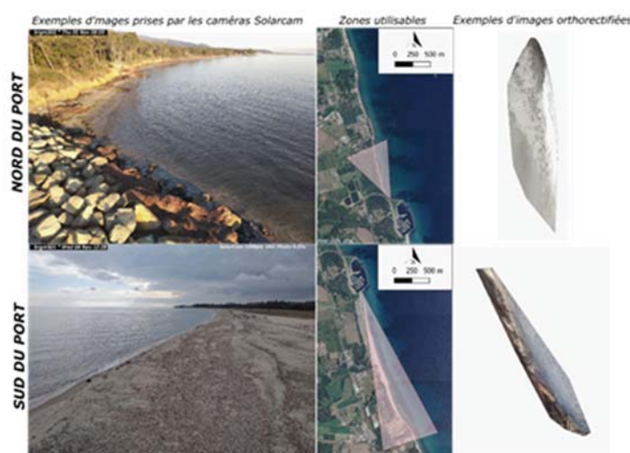
Figure 2. Emprise photographique des caméras BRGM 302 (en haut) et BRGM 301 (en bas) utilisées respectivement pour le suivi du trait de côte au nord et au sud du port de Taverna. Gauche : vues des caméras ; centre : cônes des vues projetés sur une image aérienne ; droite : images orthoréctifiées.
