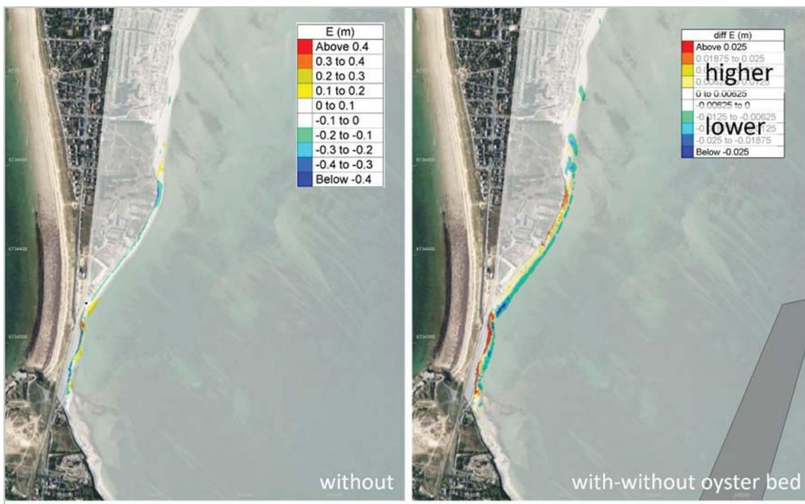
Figure 10. Evolutions de la hauteur du fond (+rouge : dépôt, -bleu : érosion) après 4 cycles de marée, associés à une tempête annuelle sans et avec le banc d'huîtres.
