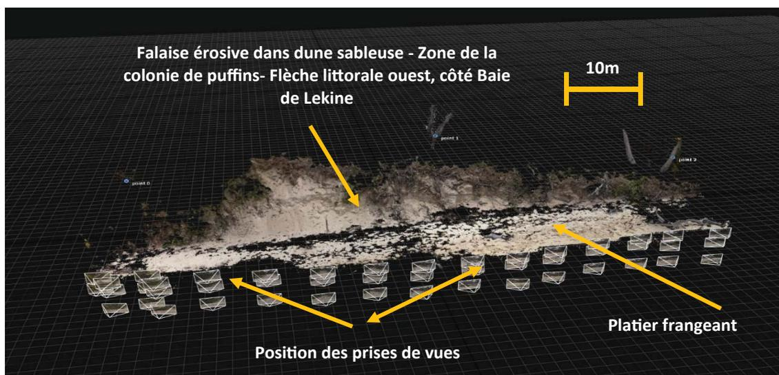
Figure 16. Exemple de levé stéréo-photogrammétrique, (Image Digiscan 3D).
