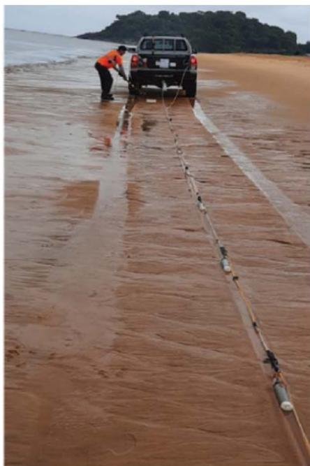
A2 - Sismomètre et enregistreur Minishark © (H/V, sismique passive)
