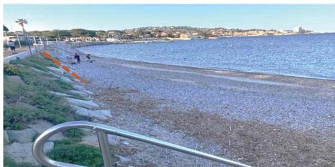
Figure 6. L'érosion de cette baie ouverte sur le SW, à l'«abri» d'un épi, signale un défaut d'accrétion structurel. Un PLT peut corriger la zone concernée en rétablissant la plage et en évitant la submersion de la digue, (Var, 2022), (URSAT & MEYER, 2022).
