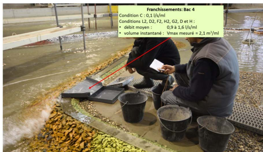
Figure 9. Mesure des volumes maximaux de franchissement sur la digue est.
