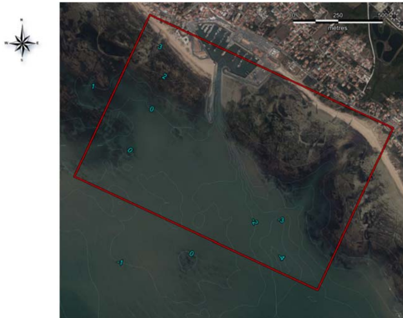
Figure 4. Bathymétrie à la côte sur photo aérienne et limites du modèle de détail de transfert à la côte (1,5km x 1 km).
