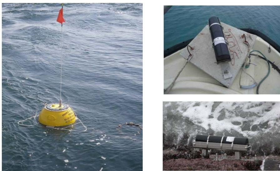
Figure 1. Bouée directionnelle DATAWELL positionnée au large par une profondeur de 20 m CM et capteurs de pression OSSI fixés sur un socle en béton, immergé à 3 m CM (capteur n° 2) et 8 m CM (capteur n° 3) et en pied de digue à -1 m CM (capteur n° 1).
